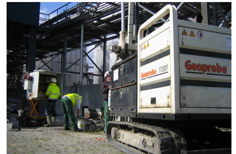
Uitvoeren MIP-sondering ter detectie van BTEX en VOC's in de haven van Antwerpen
